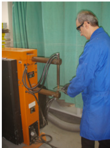
Figura 9.10 — Illustrazioni di buone e cattive pratiche nel predisporre la postazione di lavoro per una saldatrice a punti e considerare la collocazione dell'operatore
